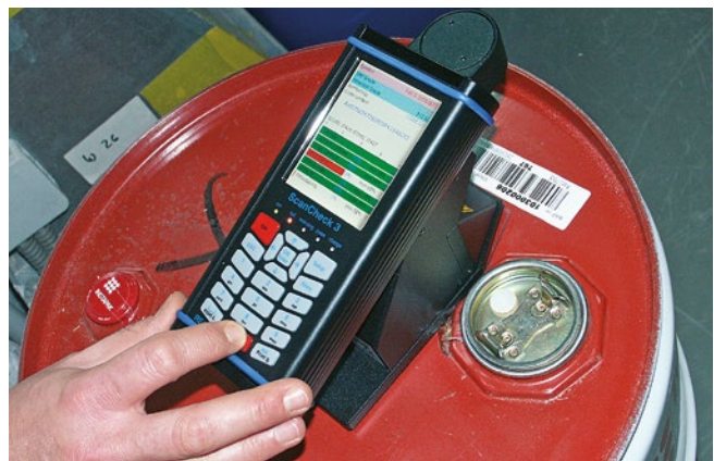
Prüfung von Barcodes auf Blechfässern
