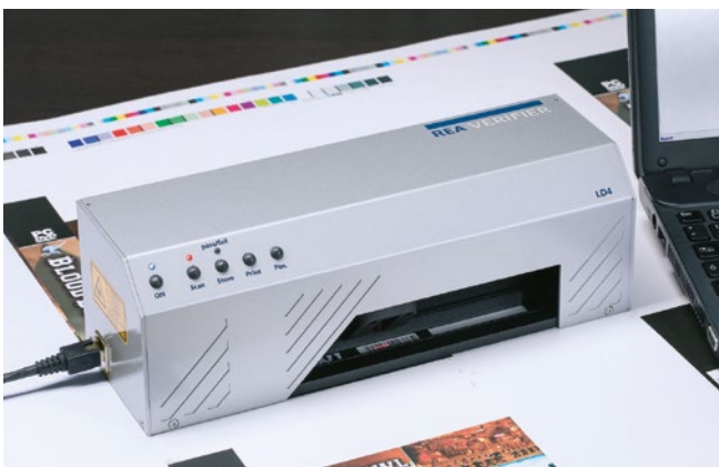
Vermessung von Barcodes auf Druckmusterbogen
