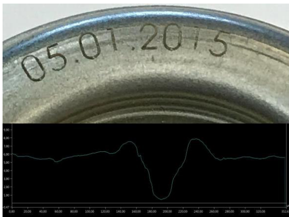
Bild 5: Begrenzung der Laser Eindringtiefe auf 6 µm
