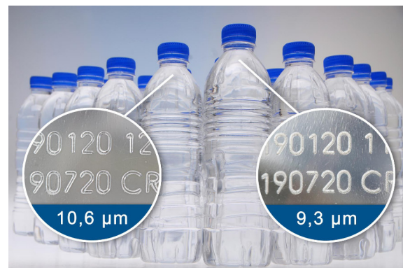
Bild 1: PET-Flaschen Kennzeichnung mit CO 2 Laser mit unterschiedlichen Wellenlängen
